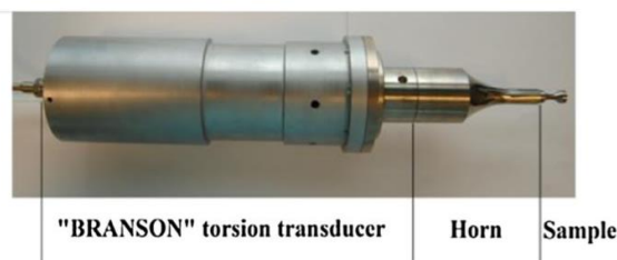
Figura 2.7 - Sistema de ressonância torsional com transdutor rotacional [13]
